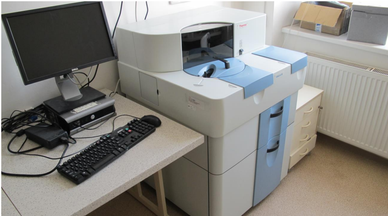
Obrázek č. 13: Biochemický analyzátor Konelab 20i
