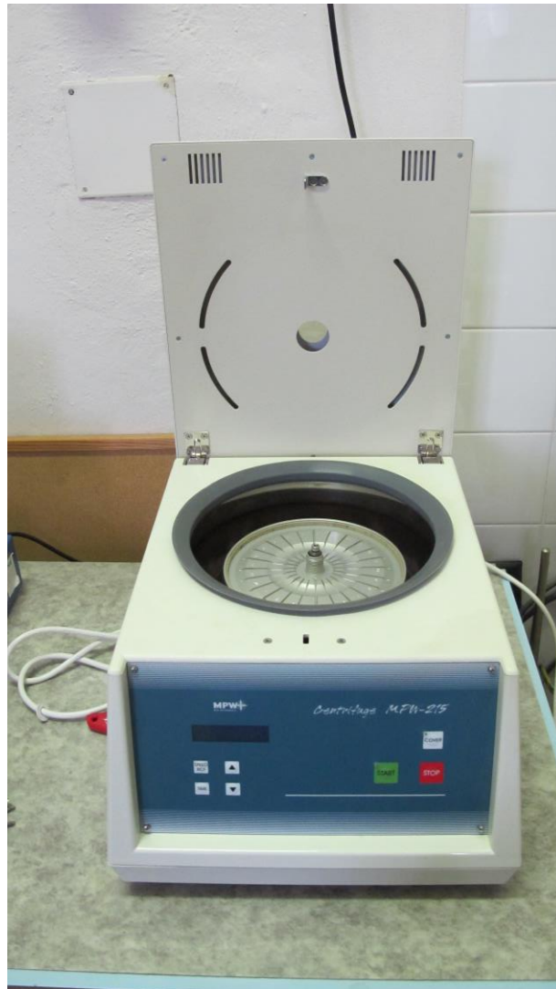
Obrázek č. 11: Centrifuga s hematokritovým rotorem pro kapiláry
